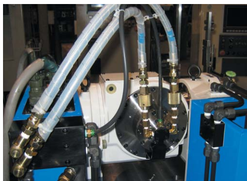
●ロータリジョイント完全内蔵 (オプション) でシンプルで確実なジグ配管を実現 Simplified pipework with complete built-in rotary joint (option)
